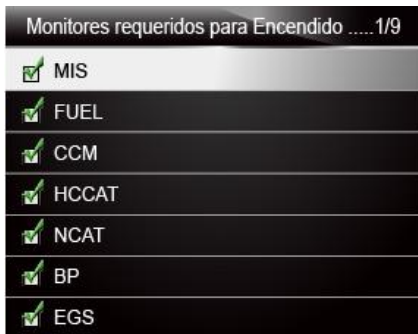
Figura 7-8 muestra pantalla de selección de monitores requeridos para encendido por Compresión.
