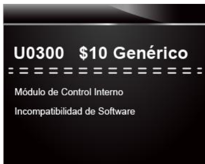
Figura 4-5 muestra pantalla descripción de DTC (código de falla)
