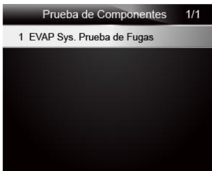
Figura 4-44 muestra pantalla de Prueba de Componentes 3. Presione la tecla Atrás para salir y volver atrás.
